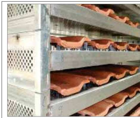
Rys. 7. MobilSystem firmy Rotho - system podstawek kanałowych dla dachówek /49/
